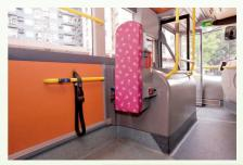
車廂下車區附近設有輪椅停放區 域,並加設扶手及下車按鈕
